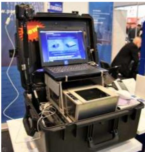
**АДИС «Папилон»** — автоматизированная дактилоскопическая информационная система, обеспечивающая гарантированные характеристики на любом массиве дактилокарт без их предварительного отбора по качеству.
